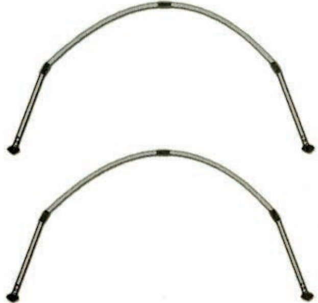
Şekil-3: Mikroseranın İki Orta Destek Bölümlerinin Çatılmış Durumu
