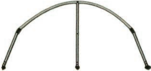
Şekil-2: Plastik Borulu Mikroseranın Ön Cephesinin Çatılmış Durumu
